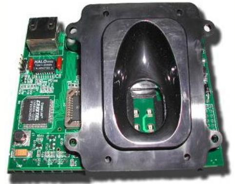
El módulo biométrico de impresiones dactilares FS84C es reconocido internacionalmente por su alta calidad, la cual ha sido certificada por el FBI. Está diseñado para ser integrado cómodamente con cualquier hardware vía interfase Ethernet o serial.
