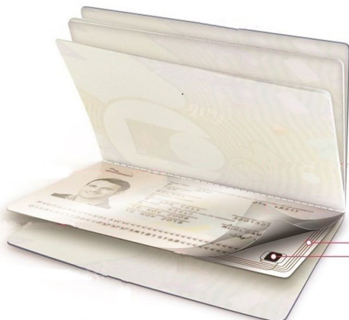
Microchip y antena embebidos en el pasaporte electrónico
