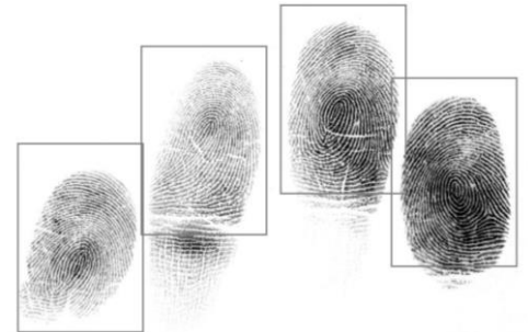
El Bioidentidad FS60 realiza la detección automática de cada dedo en las capturas simultáneas.
